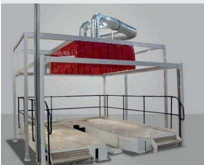
Hotte d'aspiration spéciale avec lamelles lors de l'aspiration d'un robot
